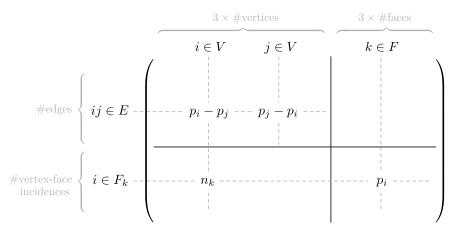
$$\#\text{columns} - \#\text{rows} = (3|V| + 3|F|) - (|E| + |VF|) = 6$$
